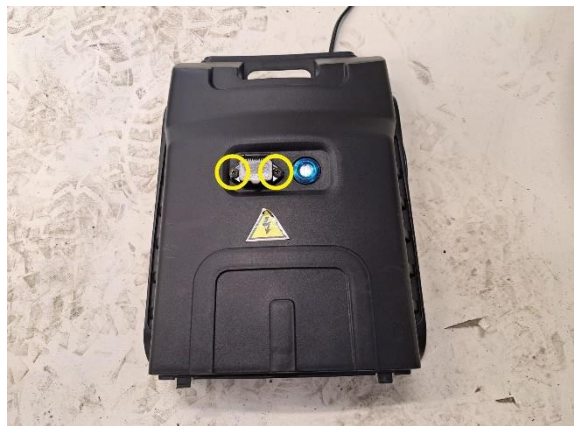
Irrota ulkoisen latausliittimen kiinnitysruuvit (ristipäämeisseli ph2).
