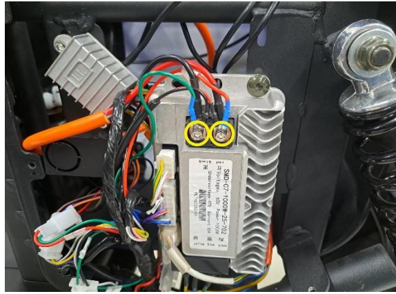
Irrota ohjainlaitteen virtajohtojen kiinnityspultit (kuusiokoloavain 4 mm).
