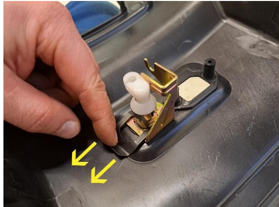
Ota istuimen lukon kiinnitysklipsi pois.
